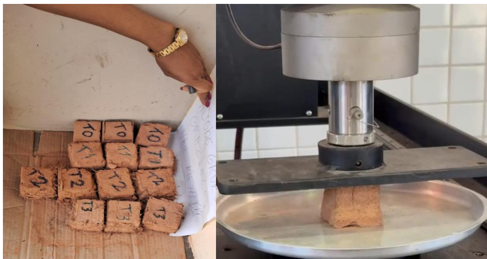
Figura 2. Blocos de adobes submetidos ao teste de resistência e a prensa controladora INSTRON EMIC 23-100 executando a prensagem.
