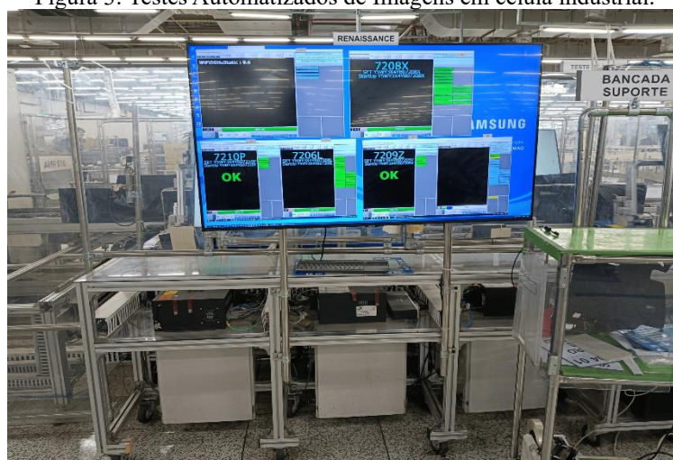
Figura 3: Testes Automatizados de Imagens em célula industrial.
