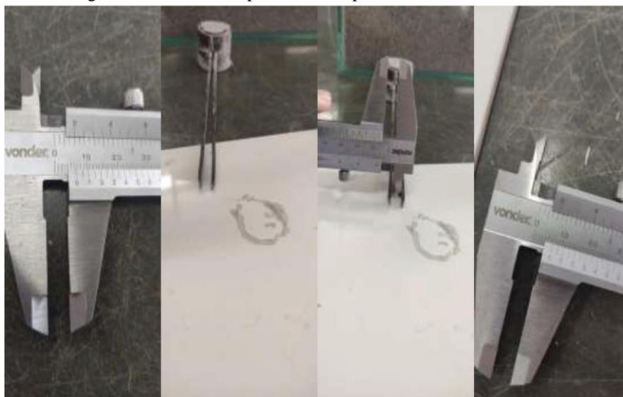
Figura 6 - Ensaio de expansibilidade pelo método de Le Chatelier
