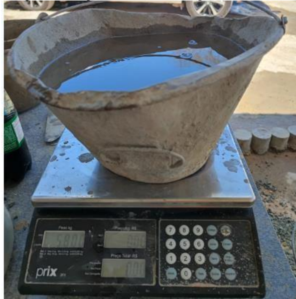
Figura 13 - Água utilizada na dosagem do concreto.
