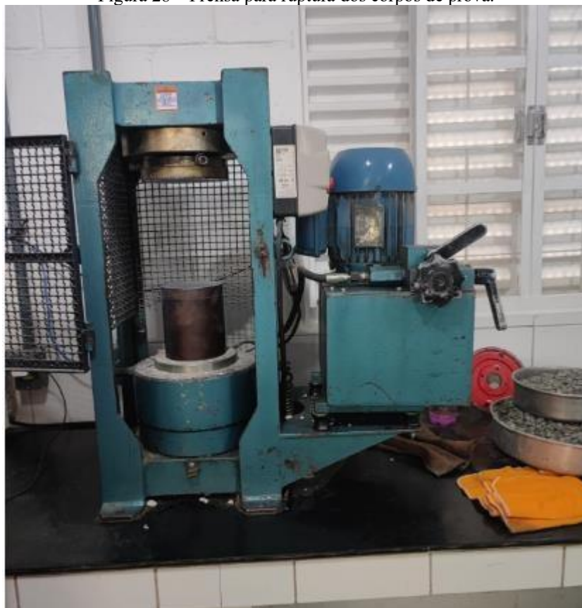
Figura 28 – Prensa para ruptura dos corpos de prova.
