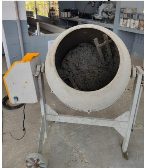
Figura 6 - Betoneira utilizada nas dosagens do concreto.
