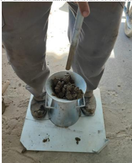
Figura 17 – Ensaio do abatimento do tronco de cone-Slump Test.
