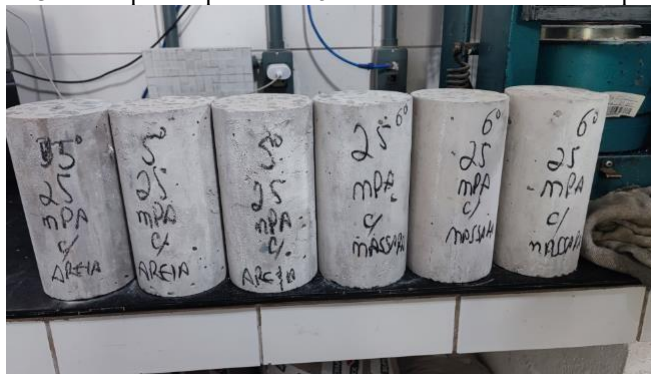
Figura 34 – Corpos de prova de 25MPa antes do ensaio à compressão.
