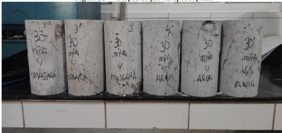
Figura 31 – Corpos de provas após ruptura.
