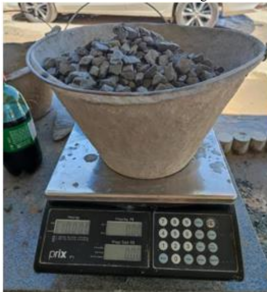
Figura 9 - Brita 19 mm utilizado na dosagem do concreto.
