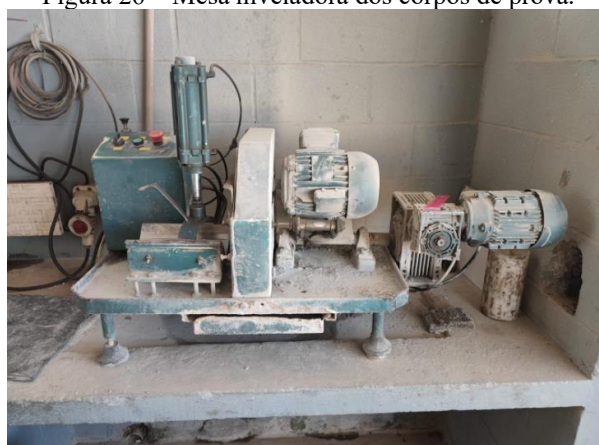
Figura 26 – Mesa niveladora dos corpos de prova.
