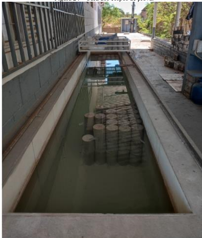
Figura 24 – Cura dos corpos de prova.
