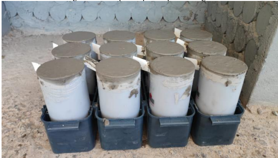
Figura 22 – Corpos de prova após moldagem.
