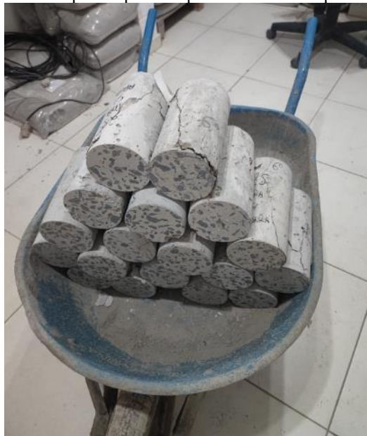
Figura 32 – Corpos de provas após ensaio de compressão axial.
