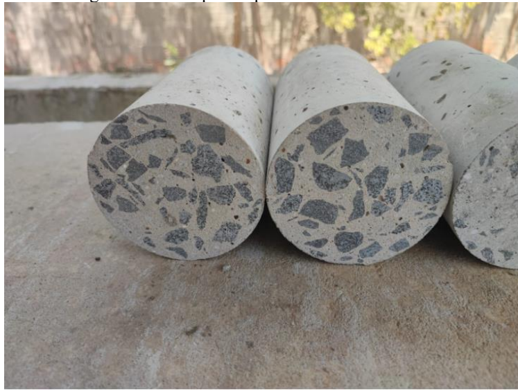
Figura 27 – Corpos de prova com bases niveladas.
