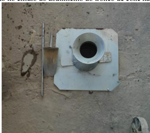
Figura 15 - Material usado no ensaio do abatimento do tronco de cone na realização do Slump Test.
