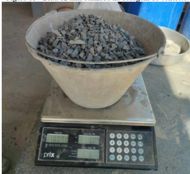
Figura 10 - Brita 12 mm utilizado na dosagem do concreto.
