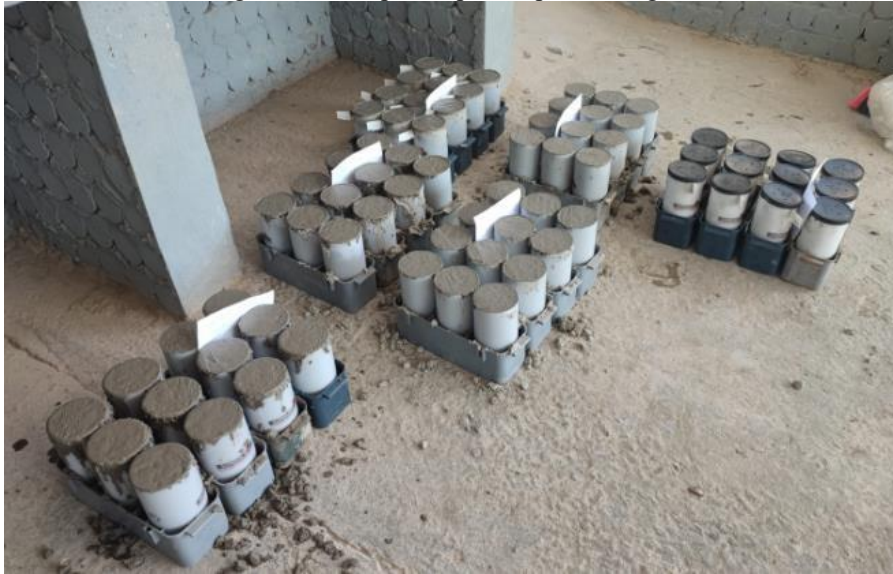
Figura 23 – Corpos de prova após moldagem.
