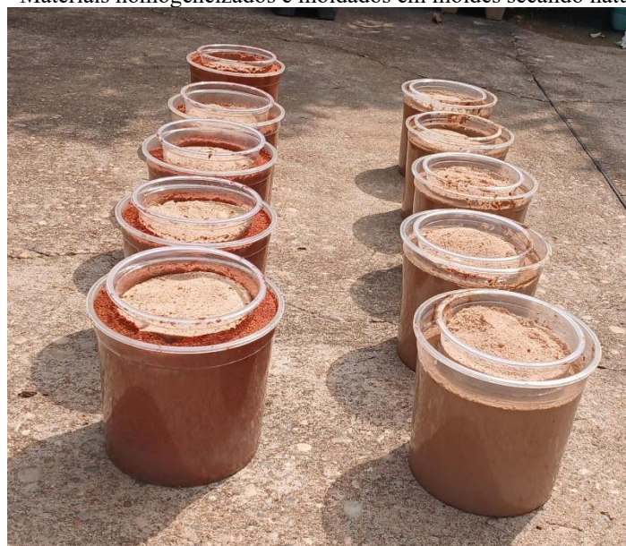
Figura 2 - Materiais homogeneizados e moldados em moldes secando naturalmente.
