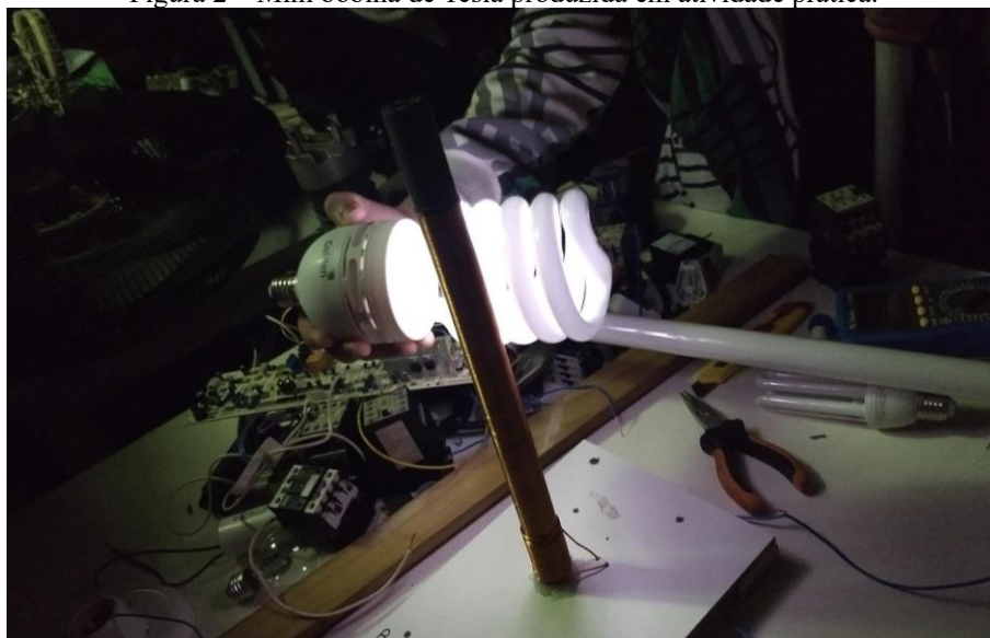
Figura 2 – Mini bobina de Tesla produzida em atividade prática.
